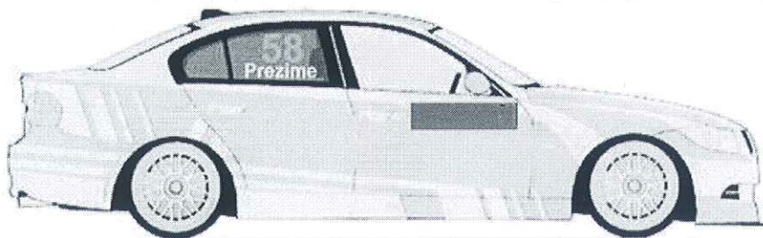
Zadnjem vetrobranskom staklu, broj je visine 14cm sa debljinom linije od 2cm, font je Arial BOLD
