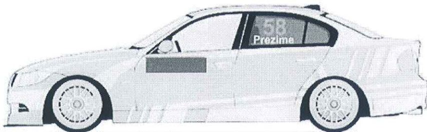
Zadnjim levim i desnim bočnim staklima, broj je visine 20cm sa debljinom linije od 2.5cm, font je Arial BOLD
