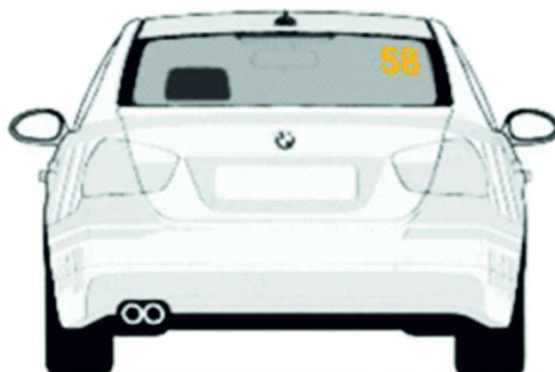
Zadnjem vetrobranskom staklu. broj je visine 14cm sa debljinom linije od 2cm, font je Arial BOLD
