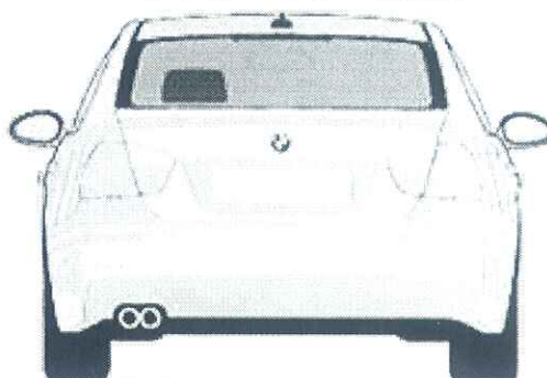
Задњем ветробранском стаклу. број је висине 14cm са дебљином линије од 2cm, font је Arial BOLD
