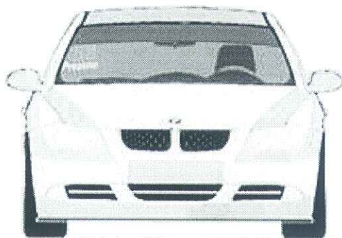
Предњем ветробранском стаклу. број је висине 14cm са дебљином линије од 2cm, font је Arial BOLD
