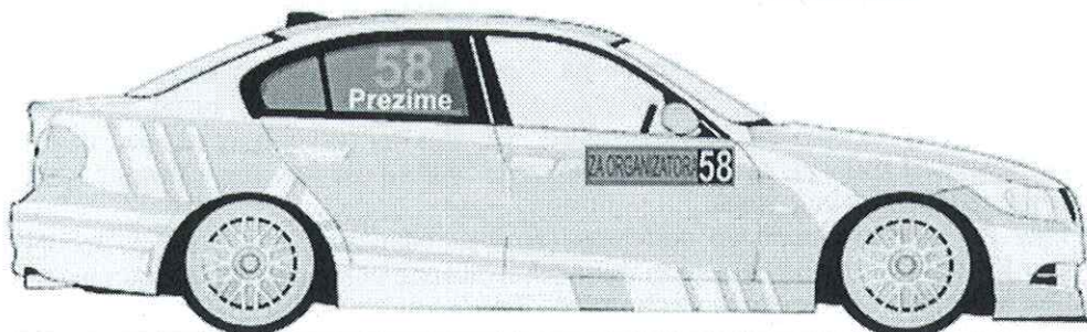
Задњем ветробранском стаклу. број је висине 14cm са дебљином линије од 2cm, font је Arial BOLD
