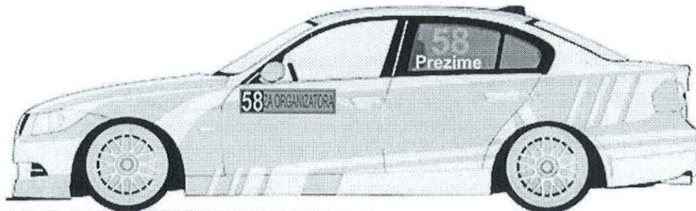
Задњим левим и десним бочним стаклима, број је висине 20cm са дебљином линије од 2.5cm, font је Arial BOLD
